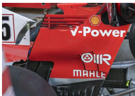
In Singapur debütierte die Heckflügel-Familie mit vertikalen Schlitzten in den Endplatten. Sie flopfte
