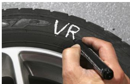
Beschriften: So weiß man, wo jedes Rad hingehört. Achsweises Tauschen sorgt für gleichmäßigen Verschleiß
