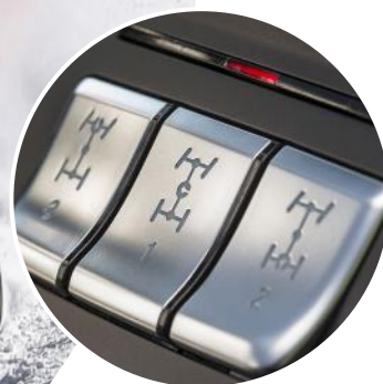
Die Technikunterschiede zwischen modischen 2WD-SUV und potenten Geländewagen sind enorm, das zeigen die drei sperrbaren Differenziale in einer Mercedes G-Klasse
