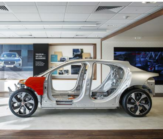
Sehr verwindungssteife Alu-Struktur und großer Radstand: Jaguar I-Pace
