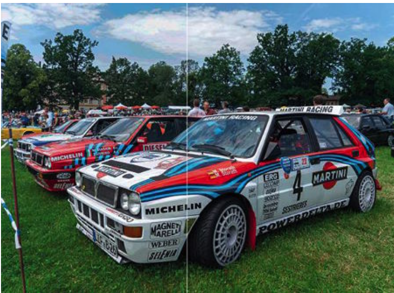
Darstellung mit 8 Bit und 24 Bit in Farbe: Die Darstellung mit 256 Farben und adaptiver Farbreduktion (links) liefert ein ansprechendes Ergebnis. Kleinteilige Bildelemente und Farbverläufe werden aber deutlich schemenhafter angezeigt als in der 24-Bit-Darstellung (rechts) mit theoretisch möglichen 16,7 Mio. Farben.
