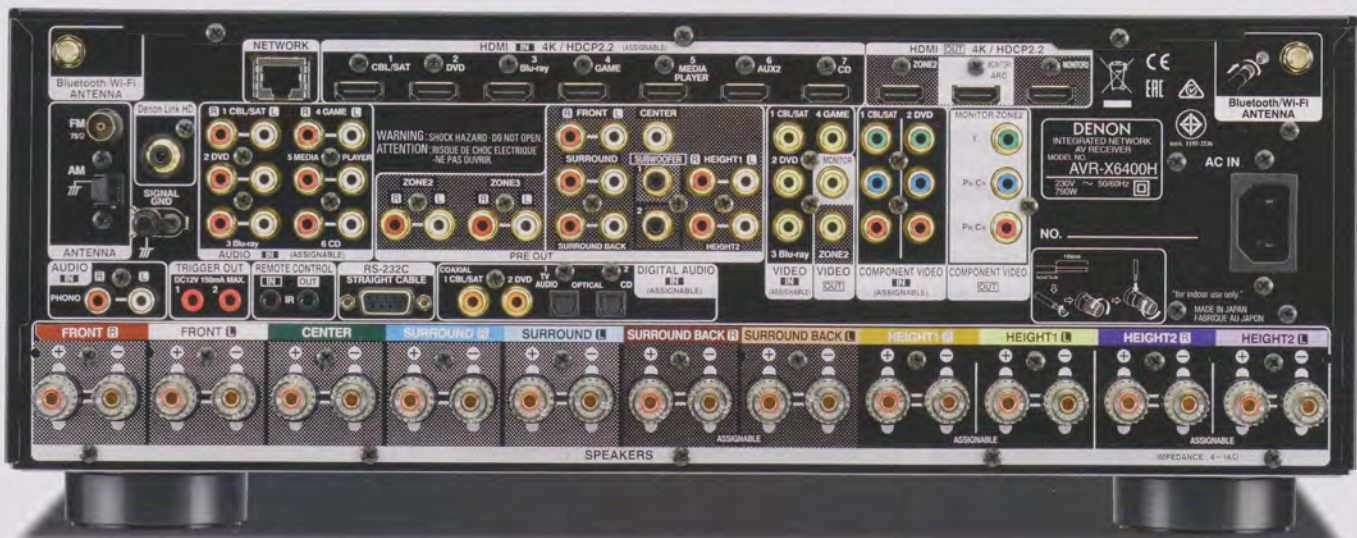
Denons AVR-X6400H verfügt über 8 HDMI-Eingänge (einer vorn) und 3 HDMI-Ausgänge; mit 4 digitalen und 7 (einer vorn) analogen Tonschnittstellen sollten keine Engpässe auftreten. Trotz 11 Endstufen gibt es 17 Pre-outs, 4 davon sind den Hörzonen 2 und 3 zugeordnet. Die aufschraubbaren Antennen sorgen für den Empfang von WLAN und Bluetooth.
