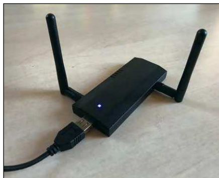
Das Pineapple Nano ist ein mobiler Rechner mit Linux und vier Netzwerken: 2x WLAN, einmal USB-Netzwerk und einem USB-Anschluss für einen mobilen LTE-Stick oder ein Android-Phone.
