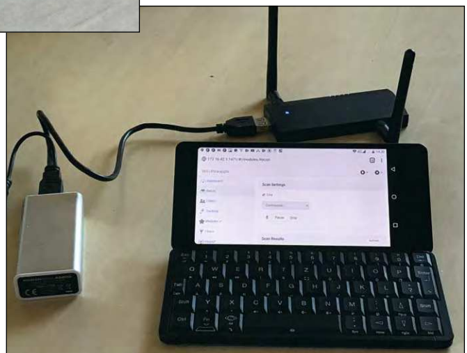
Mit Powerbank, WiFi Pineapple und Mini-PC steht einem Outdoor-Einsatz nichts im Wege. Das Android-Gerät kann dabei sogar als mobiler Internet-Zugang genutzt werden.
