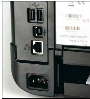
Neben USB- und LAN-Kabel lässt sich der beiliegende WLAN-USB-Dongle an der Rückseite anstecken.
