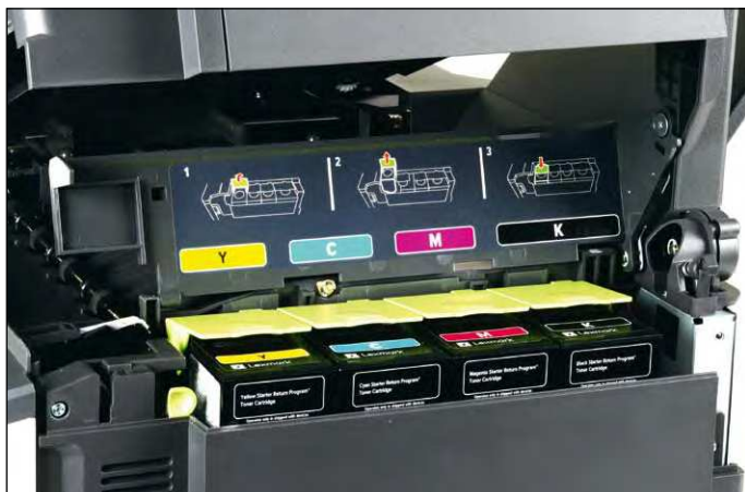
Die Tonerbehälter beim Lexmark sind ähnlich geformt wie große Tintenpatronen bei vielen Tintenstrahldruckern.
