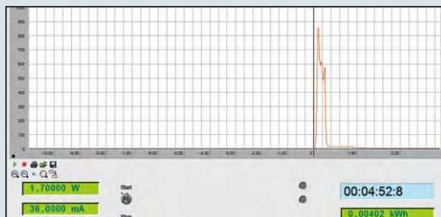
Das Leistungs-Diagramm zeigt die Stromaufnahme des jeweiligen Druckers im Betriebs- und Ruhemodus.
