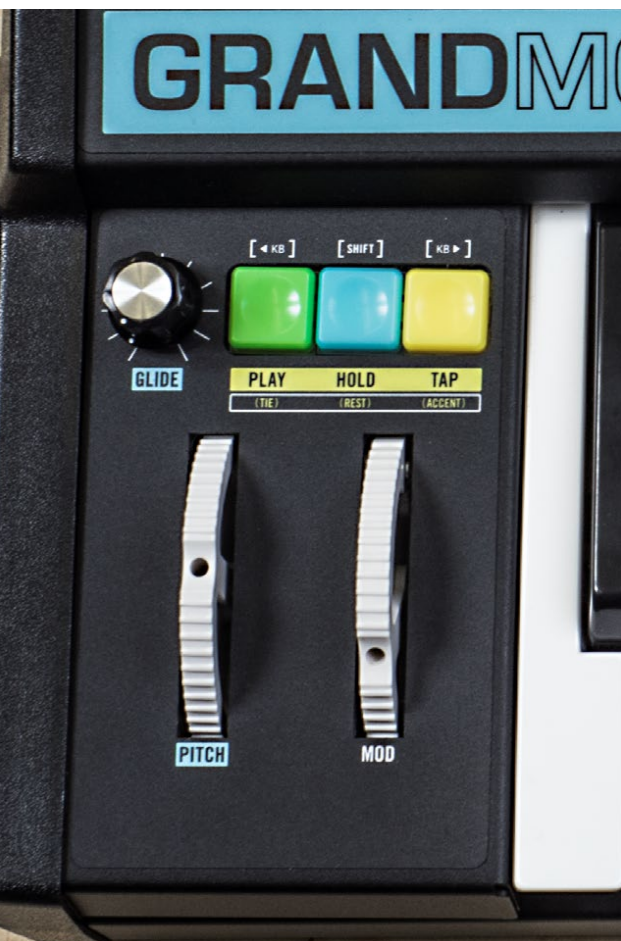
Die Sequencer-Steuerung kommt mit drei Tasten aus. Drückt man „Play“ und „Loop“ gleichzeitig, läuft die Sequenz oder das Arpeggio ununterbrochen
