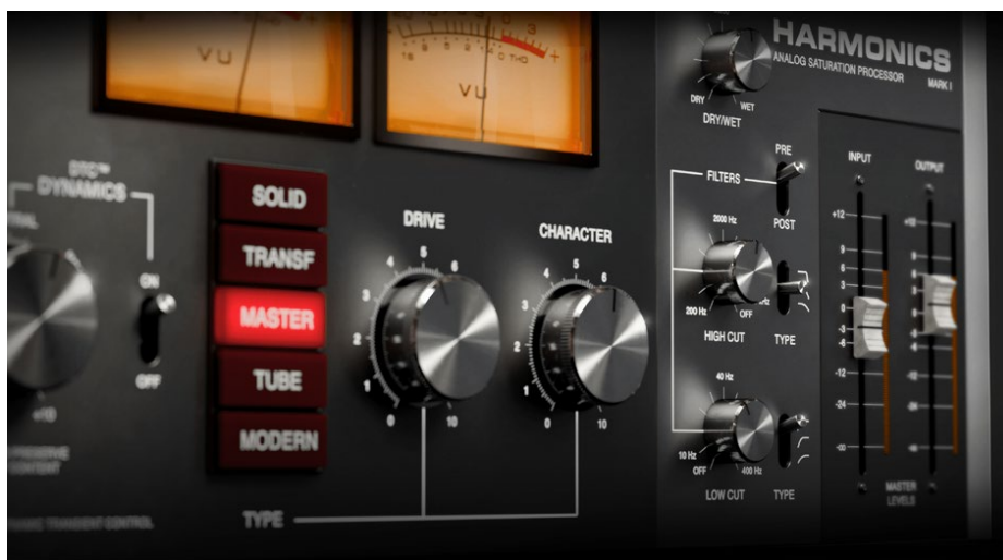
Mit Drive und Character wird die Stärke der Verzerrung und die Gewichtung der zu verzerrenden Frequenzen bestimmt.
