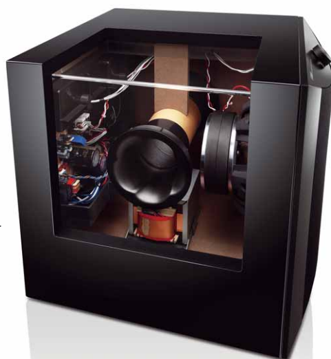
42 Kilogramm bringt der Subwoofer auf die Waage, 19 kg gehen alleine auf das Konto des ausgesteiften MDF-Gehäuses mit 25 mm und 36 mm dicken Gehäusewänden
