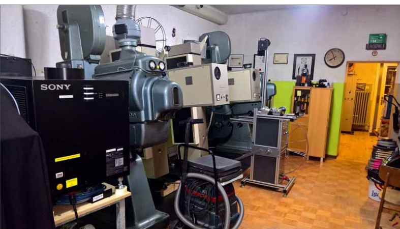
Im geräumigen Vorführraum ist die gesamte Bildtechnik untergebracht. Vorne links steht der 4K-Projektor von Sony. Dahinter reihen sich die 35- und 70-mm-Filmbandprojektoren auf. Alle Projektoren sind in einem hervorragenden Zustand und voll einsatzfähig
