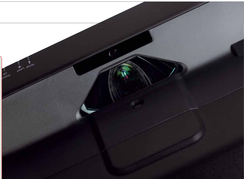
Umgelenkt – der Spiegel reflektiert das Licht von der Optik direkt auf die Leinwand, nur so ist ein großes Bild auf dieser kurzen Distanz zu realisieren
