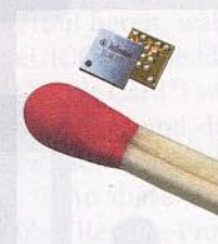
Die eSIM für M2M-Geräte kann sehr klein sein, der Infineon-Chip SLM 97 misst gerade mal 2,5 mal 2,7 mm.
