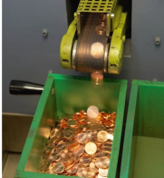
Staatliche Münze Berlin: Die automatische Prägemaschine spuckt neue Fünf-Cent-Münzen aus
