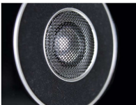
Hinter dem Gitter: In der Höhe setzt Yamaha auf eine Membran aus Aluminium und Magnesium. Die Gesamtkonstruktion ist über drei Zentimeter in der Diagonale groß. Das Ganze klingt überaus souverän und unangestrengt.
