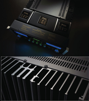
Neue Kühlrippen mit McIntosh-Logo: Wer genau hinsieht, entdeckt das Symbol „Mc“ im Alu-Stranguss-Profil der Kühlelemente. Auf denen sitzen übrigens neue Ausgangstransistoren, die die übliche Warmlaufphase – und damit zusammenhängend, die „kalte“ Klangbeeinträchtigung – nicht mehr aufweisen sollen.
