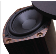
Am Boden der Box versteckt sich ein ovales, 6 x 9 Zoll großer Bassstreiber. Er spielt auf eine abgesetzte Bodenplatte, die in einem genau definierten Abstand befestigt ist.
